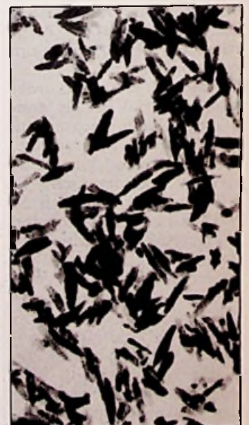
Fig. 6 De uiterst fijne magnetdeeltjes die in de magnetische laag van S-VHS band worden gebruikt.
