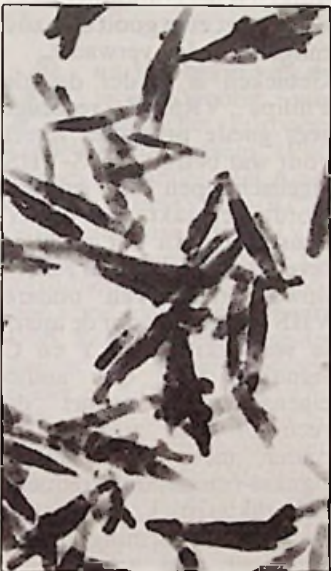
Fig. 7 Een verdere vergroting maakt duidelijk dat de magneetdeeltjes geen 'gaten' en 'kristalvorming' vertonen.
